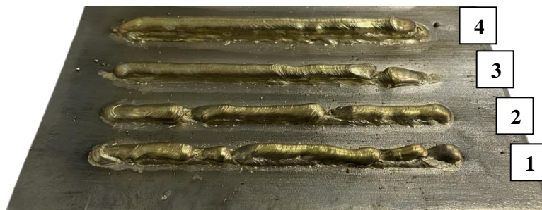
Рис. 1. Формирование наплавленных валиков при изменении сварочного напряжения
