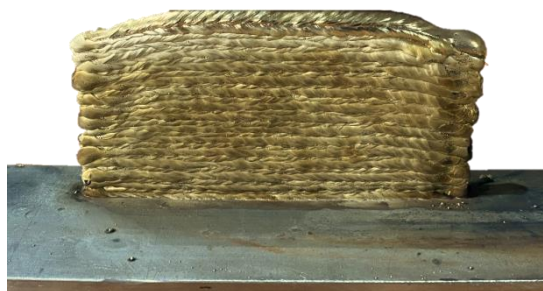
Рис. 2. 3D-печать стенки методом проволоочно-дуговой аддитивной технологии
