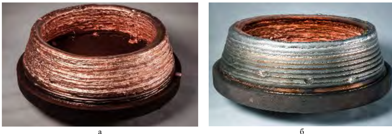
Рис. 1. Внешний вид медного конуса (а) и биметаллического (б) после печати
