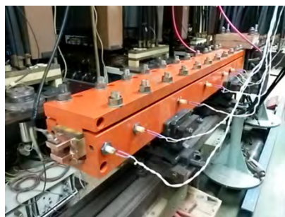
Рис. 1. Схема работы рельсотрона (а) и общий вид установки (б)
