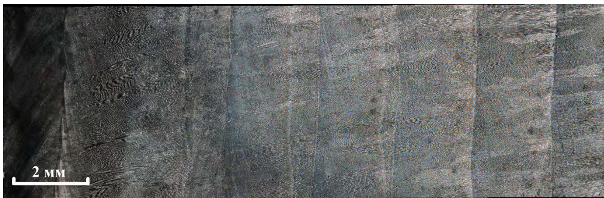
Рис.1. Макроструктура сплава системы Ni-Cr 22 -Mo 9 -Nb, полученного методом ЭДАП
