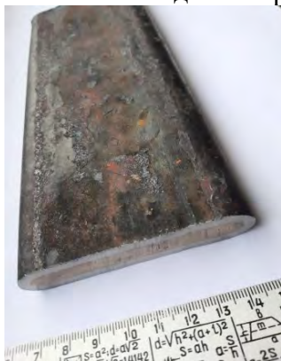
Рис. 1. Внешний вид сэндвич-пластин из монолитных СВС-композитов
