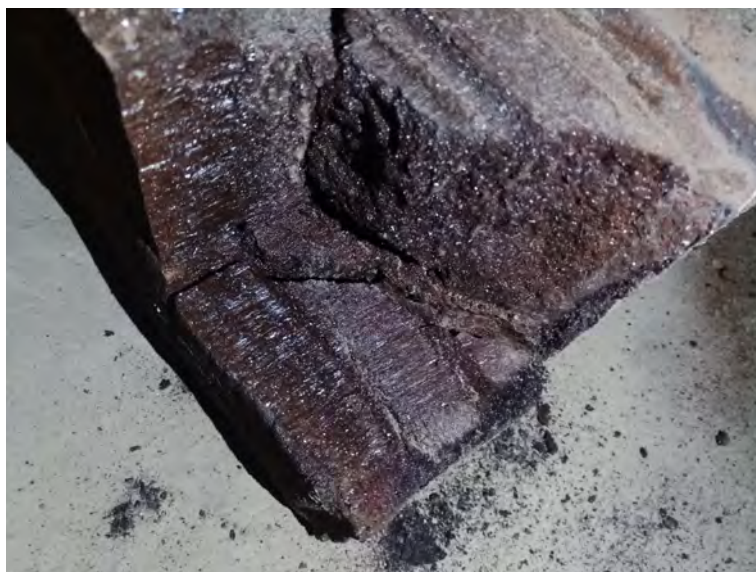
Рис. 1. Трещинообразование в футеровке свода туннельной печи на удалении от рабочей поверхности
