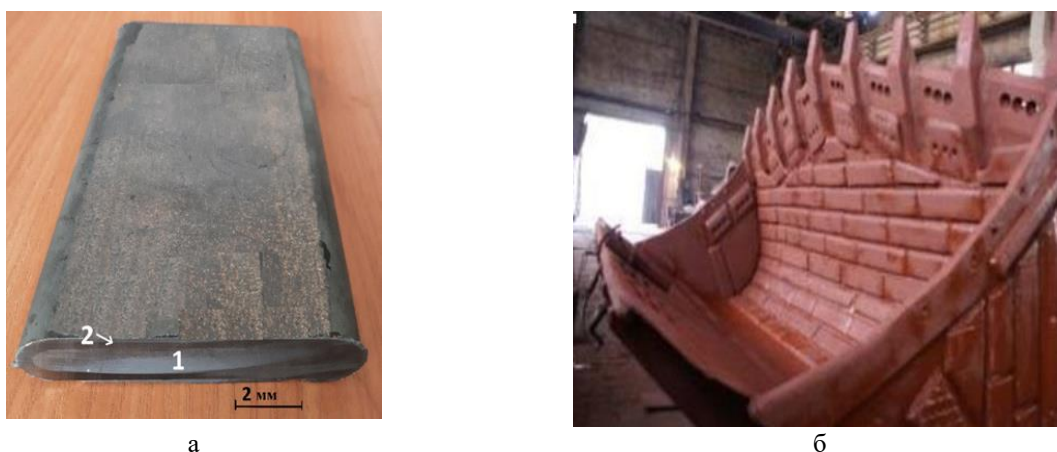
Рис. 1. Внешний вид сэндвич-пластины (а) и пример крепления пластин на ковш карьерного экскаватора (б); 1 – композит; 2 – стальная оболочка
