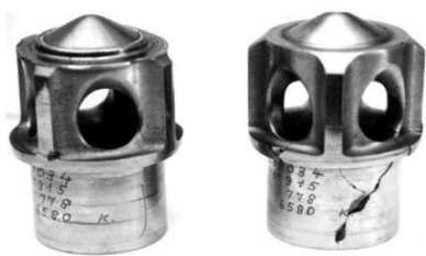
Рис. 1. Характер разрушения клапанов
