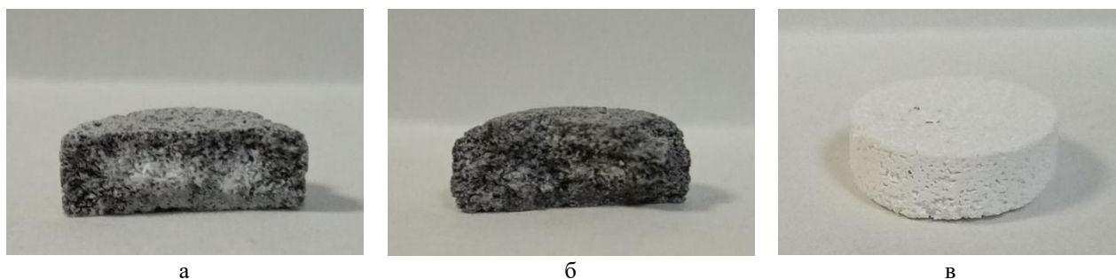
Рис. 2. Изображение пористой матрицы после двух (а) и трех (б) циклов пропитки суспензией наночастиц Al/AlN и после их окисления водой (в)
