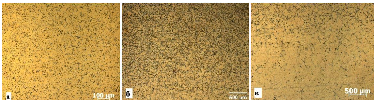
Рис. 2. Микроструктура образца, полученного методом традиционного литья (а); микроструктура верхнего слоя образца, полученного методом электронно-лучевой плавки (б); микроструктура в нижней части образца, полученного методом электронно-лучевой плавки (в)
