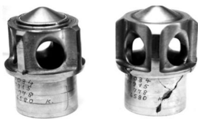
Рис. 1. Характер разрушения клапанов
