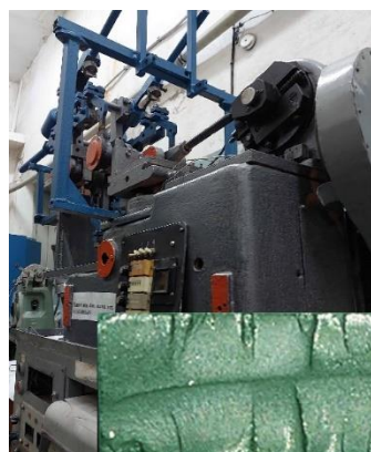
Рис. 1. Зависимость скорости роста трещины материала (сплав AA7075) от коэффициента интенсивности напряжений (после коррозионного воздействия, среда «искусственный конденсат») (а); фото оборудования для проведения механических испытаний материалов на малоцикловую усталость (с изломом образца) (б)
