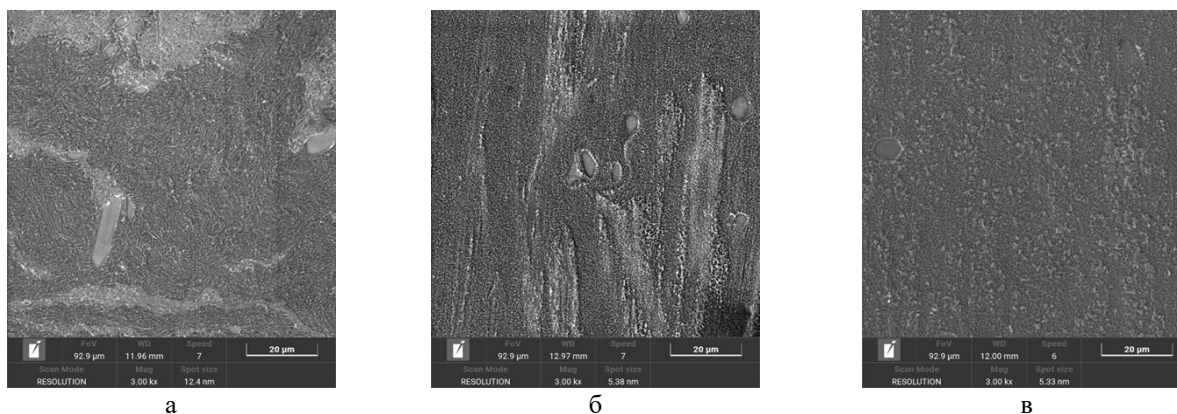
Рис. 2. Микроструктура сплава Zn-0,8%Li-0,1% Mg после ИПДК: 1 оборот (а), 5 оборотов (б), 10 оборотов (в)
